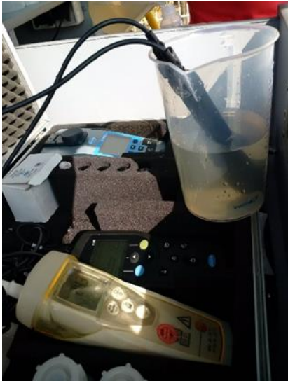
Abb. 10: Geräte für die Messung von pH-Wert, Leitfähigkeit und Sauerstoffgehalt vor dem Abfüllen von Proben (LANUV NRW 2025a).
