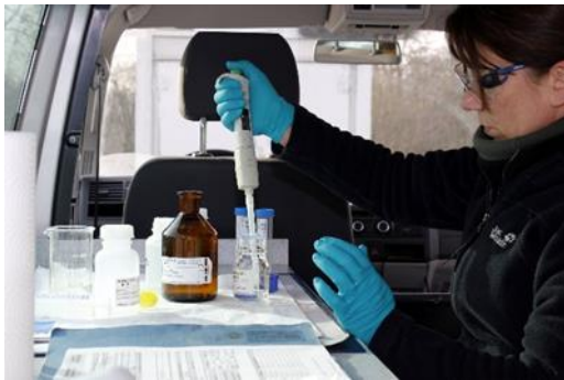
Abb. 8: Konservierung nach der Probenentnahme im Gelände (LANUV NRW 2025b).
