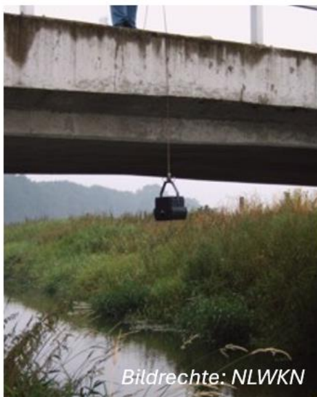
Abbildung 6: Schöpfkelle zur Sedimentprobenahme (Niedersächsischer Landesbetrieb für Wasserwirtschaft, Küsten- und Naturschutz 2012, aktualisiert 2021, veränderte Darstellung).
